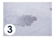
Nach rund 3-4 Minuten ist der Wassertropfen vollständig in den Untergrund eingedrungen. Der Tropfen sollte mattfeucht aufgetrocknet sein.
