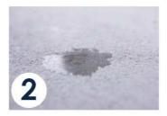
Schon kurz nach dem Aufsetzen muss der Untergrund ein gutes Benetzungsverhalten aufweisen. Der Tropfen spreizt auf.
